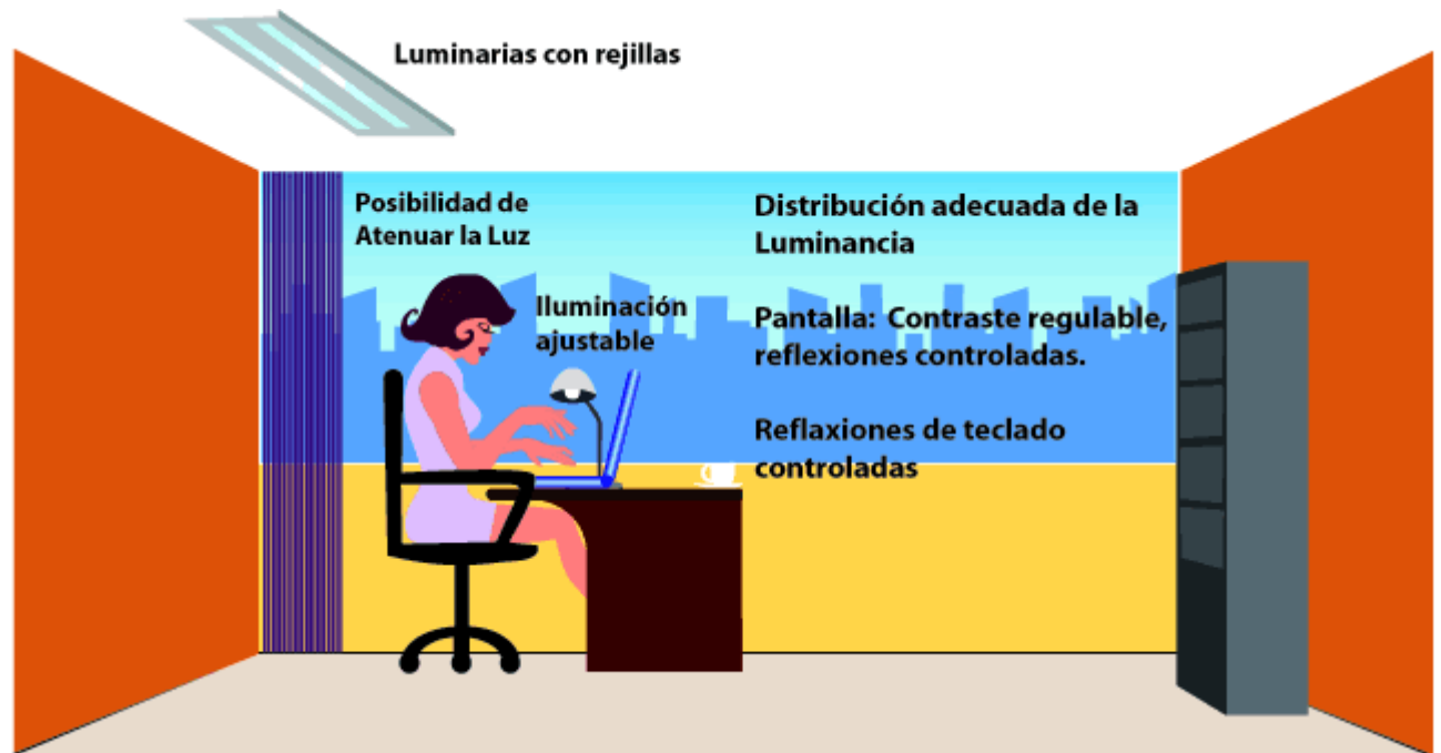
Iluminación y puesto de trabajo
